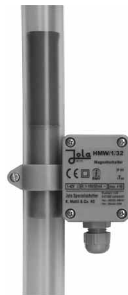
Przełącznik HMW/1/32 zamocowany do przeźroczystej rury wykonanej z PVC zawierającej pływak z pp
